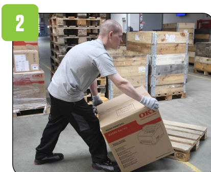
Sørg for at du har god plads. Skal du dreje kassen til venstre - sættes højre fod forrest
